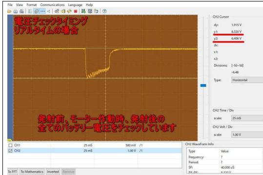
バッテリー出力が銃のセッティングに対して見合っていない場合、無理に動かしてバッテリーが発熱する前にエラーが出て動作を停止します。
