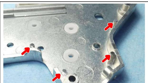
メカボックス（右）のコードを押さえる 4 か所の突起は本製品の後方配線モデルでは必ず切除してください。
