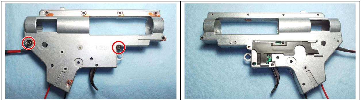
仮止めなので1~2か所ネジ止めして、セレクタープレートを装着します。
