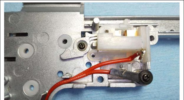
スイッチを固定しているネジ (2×4) をプラスドライバーで外すと、スイッチとトリガーを取り出せます。
