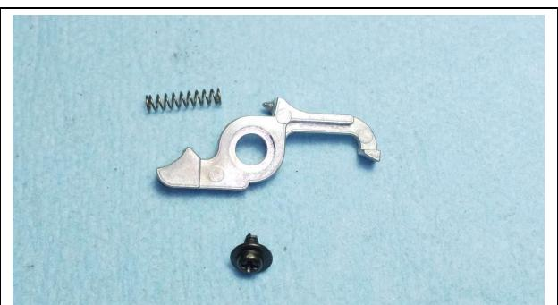
矢印のネジ (フランジ付き 2×4) をプラスドライバー (1番) で外すとカットオフレバーを取り外せます。
