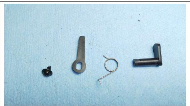
矢印のネジ（フランジ付き 2×4）をプラスドライバー（1番）で外すとトリガーセーフティが取り外せます。
